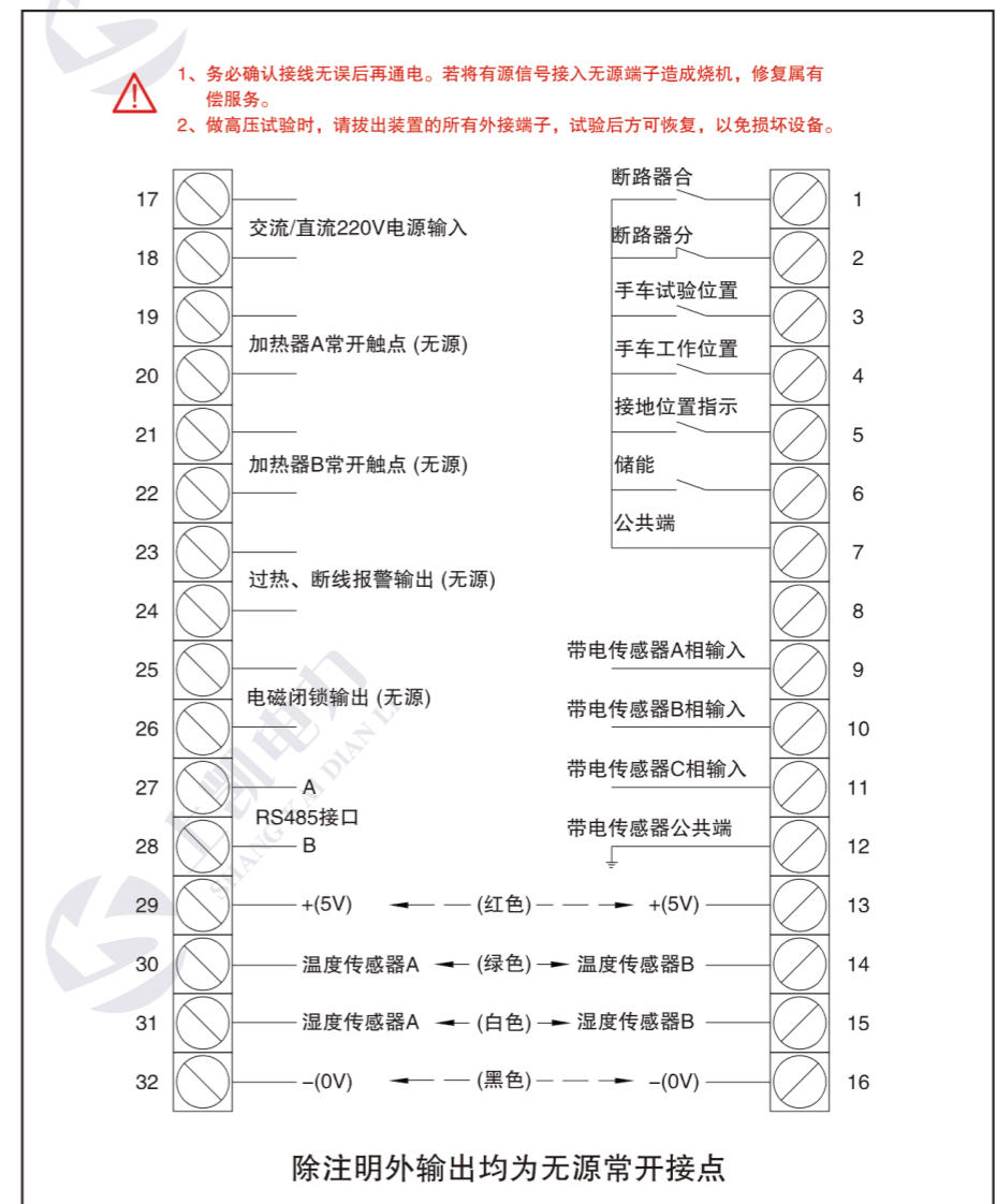
图8 SK-ZCK端子接线图
