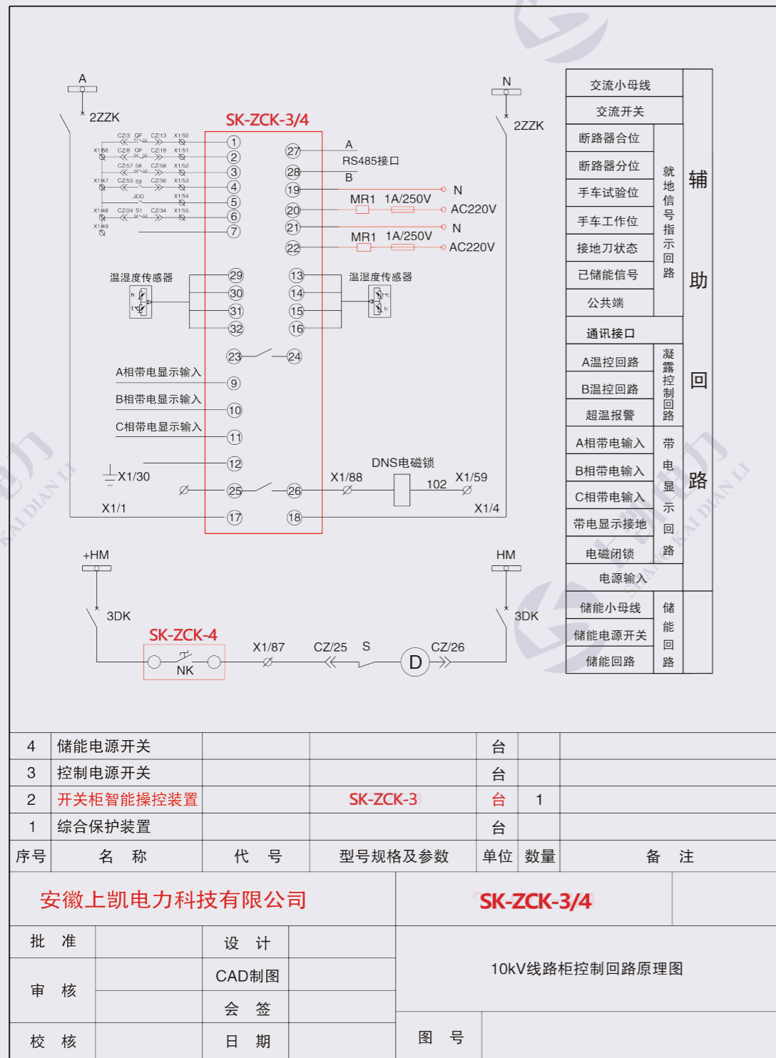
图7 SK-ZCK型二次回路原理图
