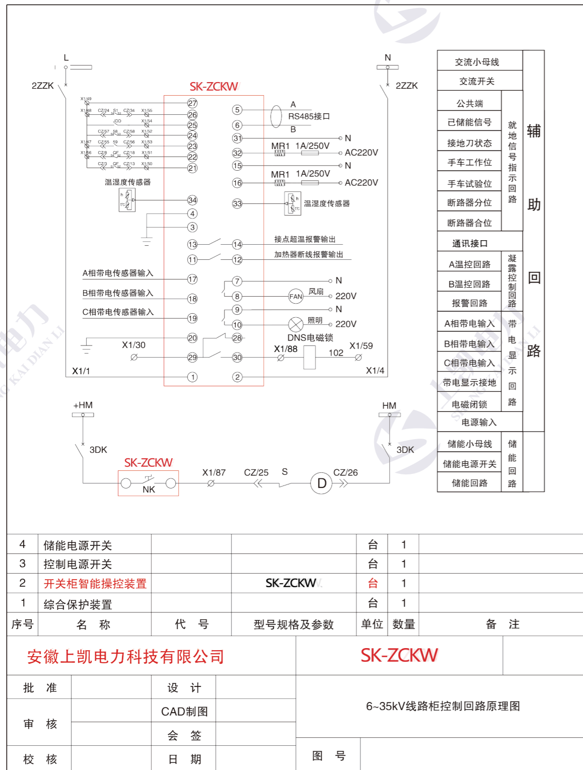
图4 SK-ZCKW型二次回路原理图
